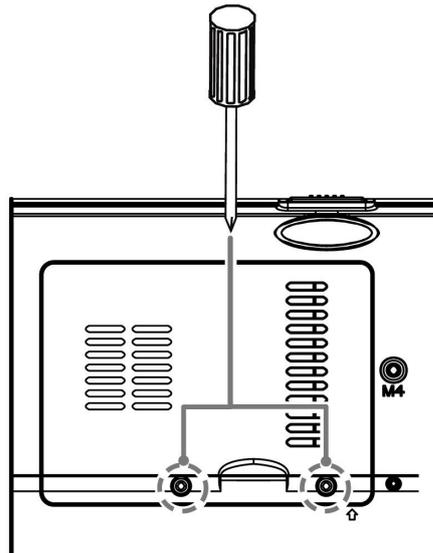
2. Снимите крышку отсека лампы.
