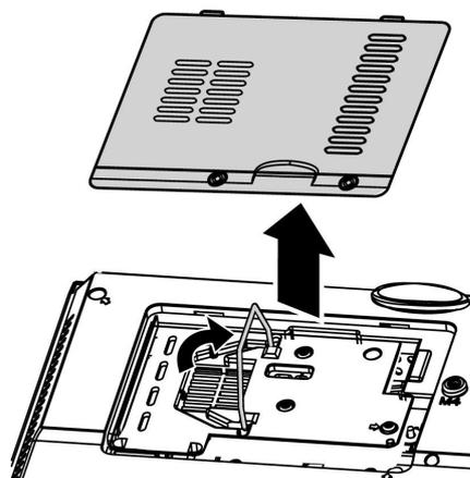
3. Выкрутите два винта на блоке лампы.
