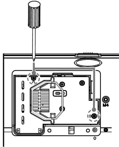
5. Выньте блок лампы, с усилием потянув за ручку блока
