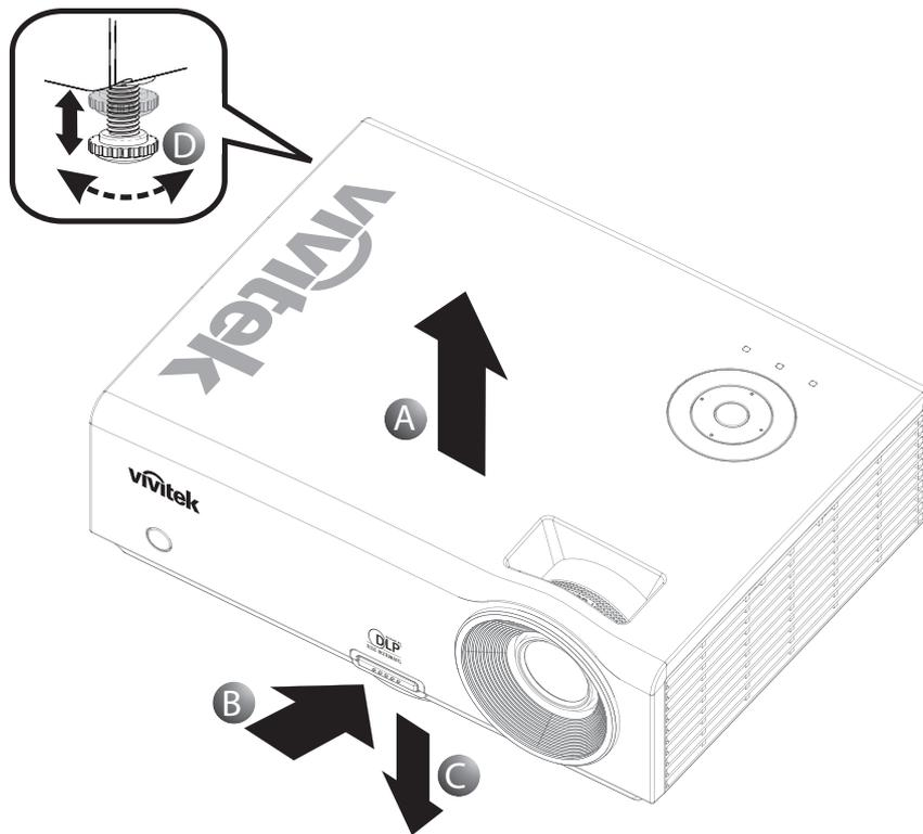
1. Для увеличения высоты проектора приподнимите проектор [A] и нажмите кнопку регулятора высоты [B].
