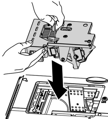
**Примечание:** Перед тем, как закрутить винты крышки отсека, убедитесь, что блок лампы плотно вошел в отсек и что разъем лампы надежно соединен с разъемом отсека.
